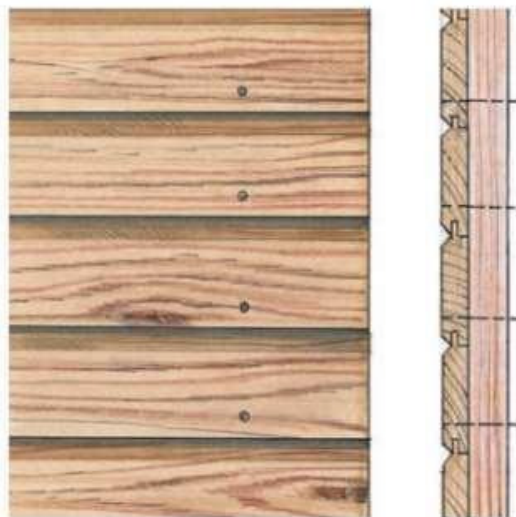
Figur 71 Brædderne med fer og not skal være forsynet med tilstrækkelig fer/not-størrelse til at optage de fugtbetingede bevægelser. Brædderne opsættes med feren opad. Brædder bredere end 145 mm kan med fordel fastgøres med 2 søm/skruer.
